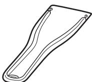
Dégivrez le compartiment de congélation dès que la couche de givre à la surface de l'évaporateur atteint 3 ou 4 mm. Lorsque vous dégivrez l'appareil, enlevez tous les aliments et réglez le thermostat sur la position « OFF ». Placez le bac d'égouttement sous l'évaporateur pour recueillir l'eau dégelée. Une fois que le givre a fondu, jetez l'eau dégelée et séchez l'intérieur du réfrigérateur.
